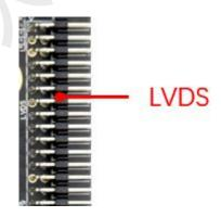
通用的 LVDS 接口定义,支持单/双,6/8/10 位 1080P LVDS 屏。屏电压可以通过跳线帽进行选择,可选择支持 3.3V/5V/12V 屏电源供电。
