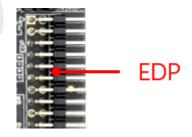
该接口为常见的 EDP 屏接口,形式为 10\*2 双排插针,屏电压可以通过跳线帽进行选择,可选择支持 3.3V/5V/12V 屏电源供电。
